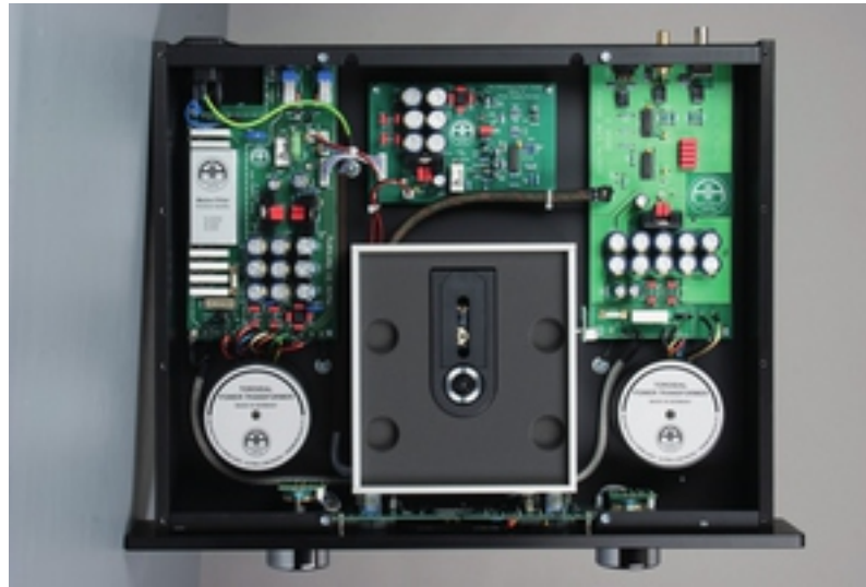
Wejściowy filtr zasilania. Transport Philips CD Pro 2 w aluminiowej kapsule. Dwa toroidy 50 VA i ponad 66000 \mu F pojemności filtrującej. Wyjścia separowane transformatorami Pulse 65612 NL.
